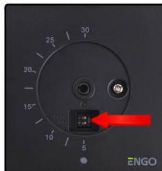
Дополнительные функции регулятора ESIMPLE230W / ESIMPLE230B можно включать и отключать с помощью переключателей, расположенных под ручкой на передней крышке. Эти функции описаны в таблице ниже:
