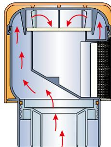
Когда давление в стояке равно или больше атмосферного, клапан закрыт, и канализационные газы из канализации не могут попасть в помещение.
