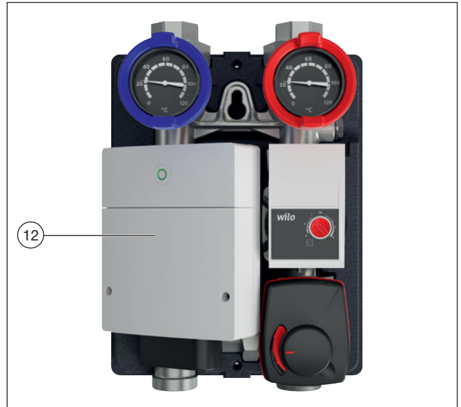
5/2 Комплект підключення до опалювального контуру HSM зі змішувачем з вбудованим модулем MM100 для керування контуром опалення
