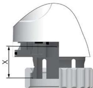
EMO TM разработан для всех типов клапанов IMI TA/IMI Heimeier и распределительных систем для напольного отопления с присоединением M30x1,5. Рабочий диапазон привода соответствует  $X = 11,10 \text{ мм} - 15,80 \text{ мм}$ .
