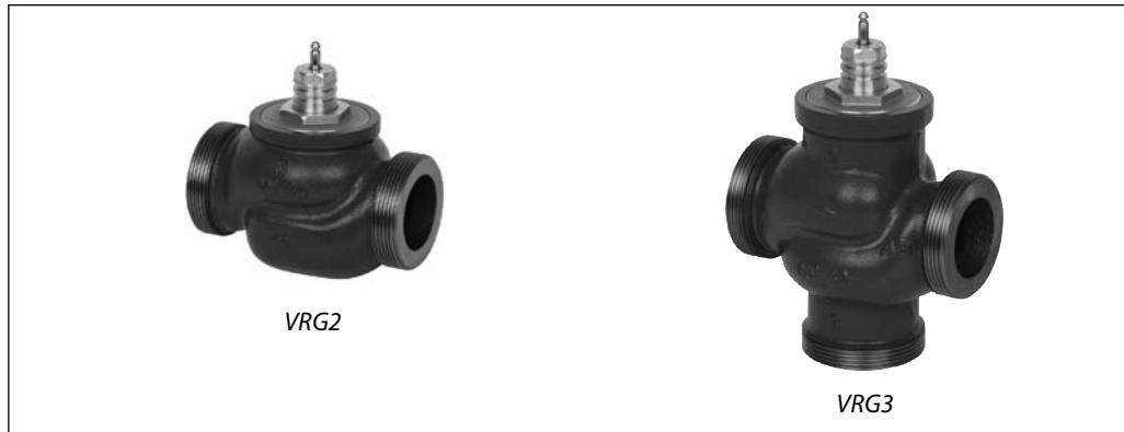
Сідельні регулювальні клапани VRG2 (двохходові), VRG3 (трьохходові) застосовуються з редукторними електричними приводами типу AMV435, що керуються імпульсним сигналом та типу AME435, які можуть використовуватися з будь-яким різновидом аналогового керуючого сигналу (0(2)...10 В чи 0(4)...20 мА) для регулювання витрати тепло- / холдоносія в системах опалення та охолодження відповідно.
