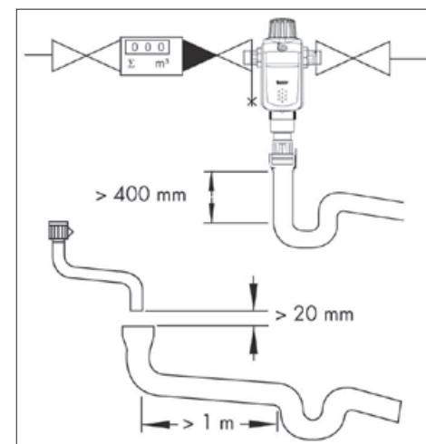
**Примечание.** Согласно требованиям DIN EN 1717, шланг для удаления промывочной воды следует закрепить на расстоянии не менее 20 мм над максимально возможным уровнем сточных вод (свободный сток).
