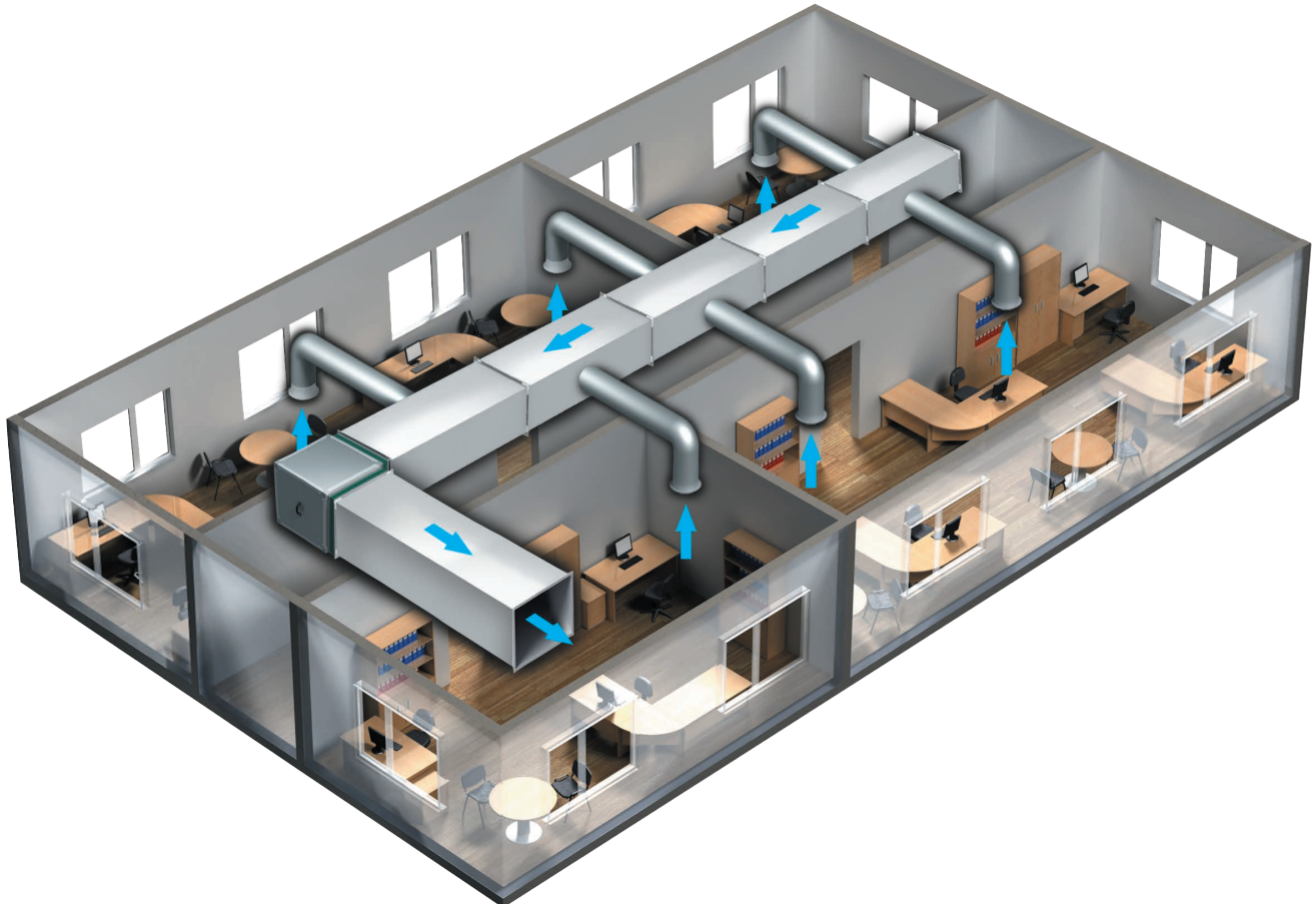
Варіант застосування вентилятора ВШ ЕС в офісному приміщенні
