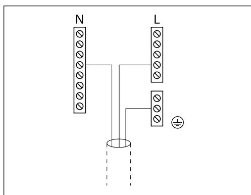
Общая клемма заземления  $\ominus$  используется для подключения соответствующих компонент (насосы, регулирующие клапаны с электроприводом).
