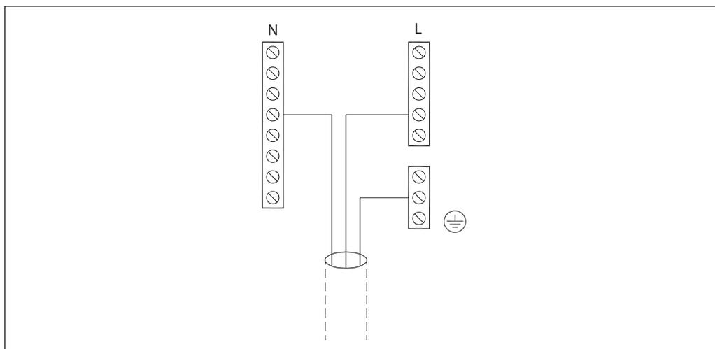
Общая клемма заземления используется для подключения соответствующих компонентов (насосы, регулирующие клапаны с электроприводом).
