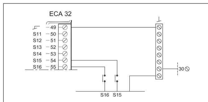
**Подключение расходомеров с импульсным сигналом (для приложения А376.9)**
