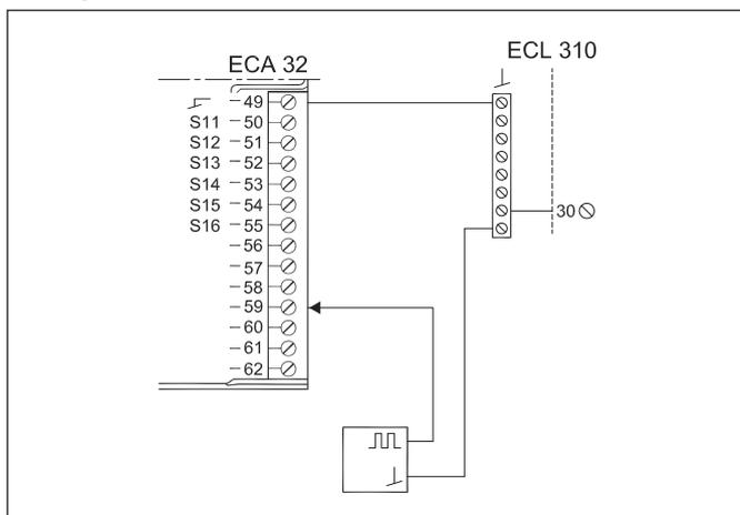
**Подключение датчиков давления с выходным сигналом 0–10 В (для приложения А376.9)**
