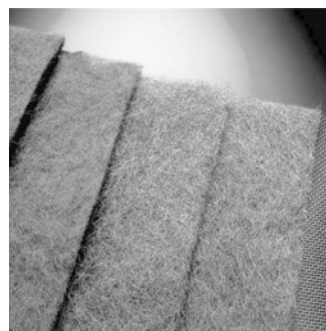
Нетканый материал из металлических волокон (высококачественная сталь) для фильтрации с закупориванием пор
