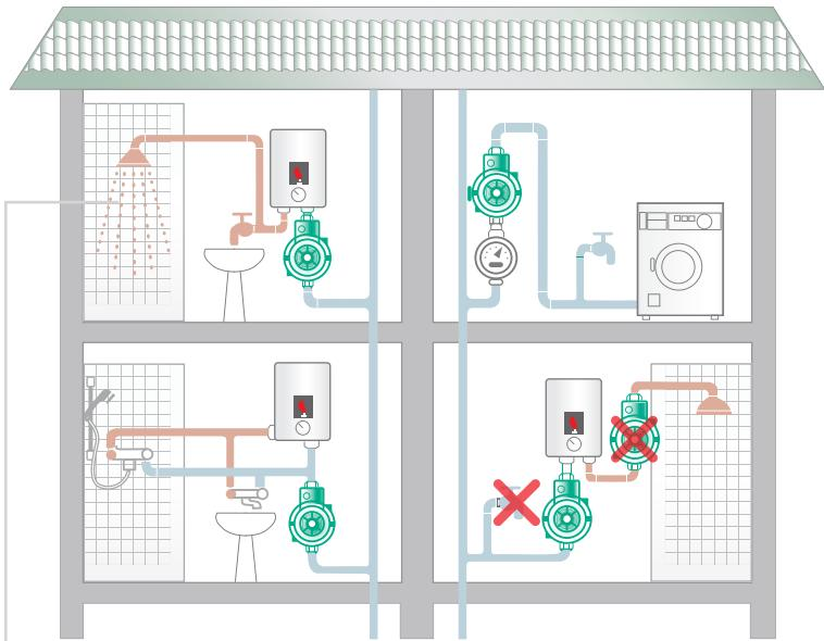
Автоматична робота насоса можлива, якщо проток води не менший, ніж 2л/хв.
