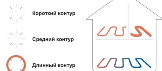
Система с автоматической балансировкой в случае резкого повышения расхода
