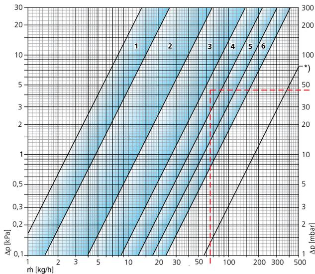
Термостатическая вставка VHV8S с 8 бесконечно регулируемыми значениями предварительной настройки
